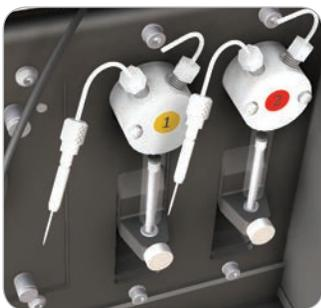
Integrierte Reagenz-Injektoren für gleichzeitige Injektion und Messung.
